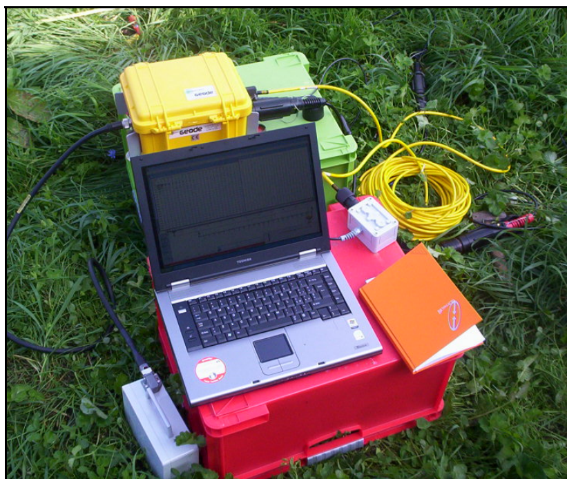
Figura 2: Strumentazione utilizzata per la prova MASW.
